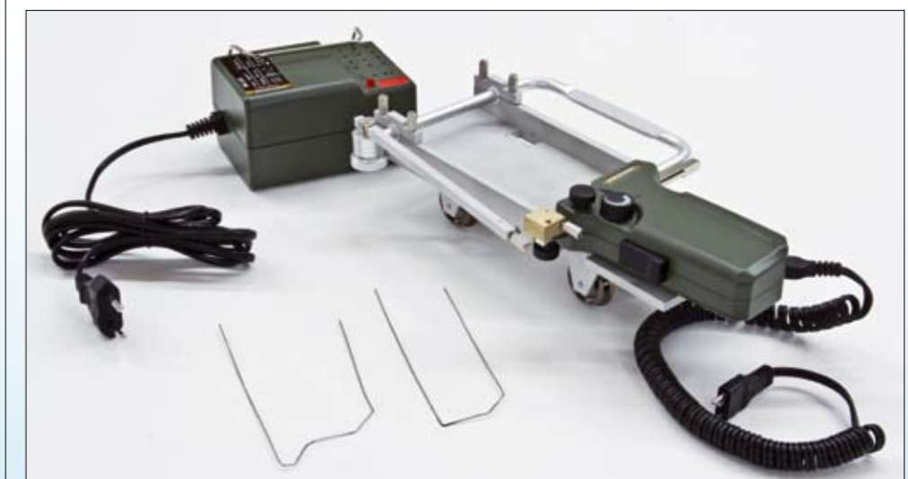
Der Proxxon-Heißdrahtschneider auf dem speziellen Spurl-Trägerwagen von SpurenWelten montiert; im Hintergrund das Netzgerät, welches im Betrieb auf dem noch freien Ausschnitt des Wagens platziert wird; mittig die beiden Schneidedrähte für den Bahnkörper / die Böschung nach NEM 122, links mit, rechts ohne Seitengraben
