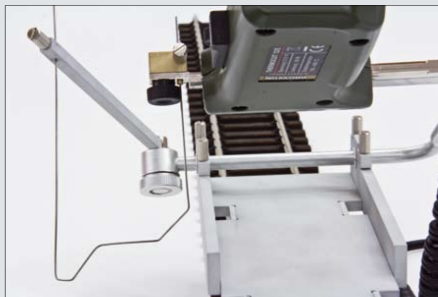
Der Schneidedraht lässt sich mittels Rändelschrauben ganz einfach in den Halterungen des Böschungsschneiders fixieren und kann jederzeit nachjustiert werden
