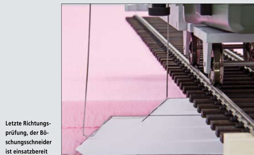
Der Schneidedraht entsprechend NEM 122, hier in der Version mit Seitengraben, für Spur1; der schräge Ausschnitt am Schotterbett erfolgt etwa 2 mm unterhalb der von der NEM vorgesehenen Kante, so dass nach dem Einschottern ein normgerechter Bahnkörper entsteht, die Hartschaumauflage endet unterhalb der im Bild eingezeichneten, roten Linie
