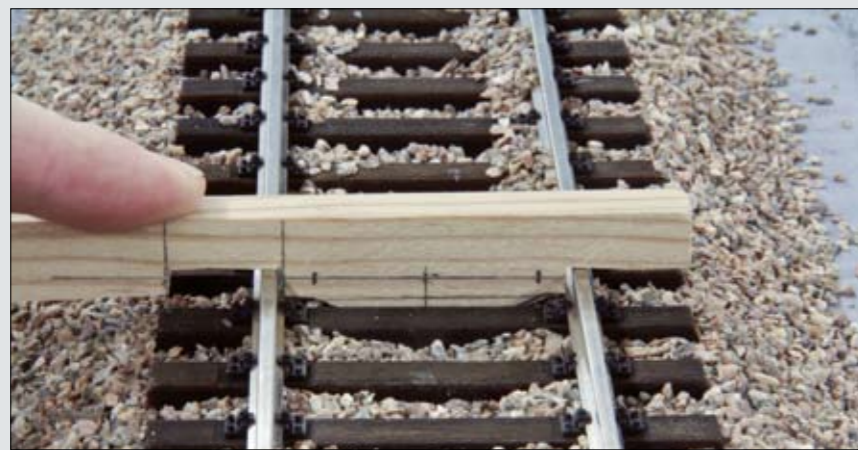
Mit einem eigens angefertigten Stempel wird der Schotter im zweiten Durchgang zwischen den Schwellen ausgerichtet
